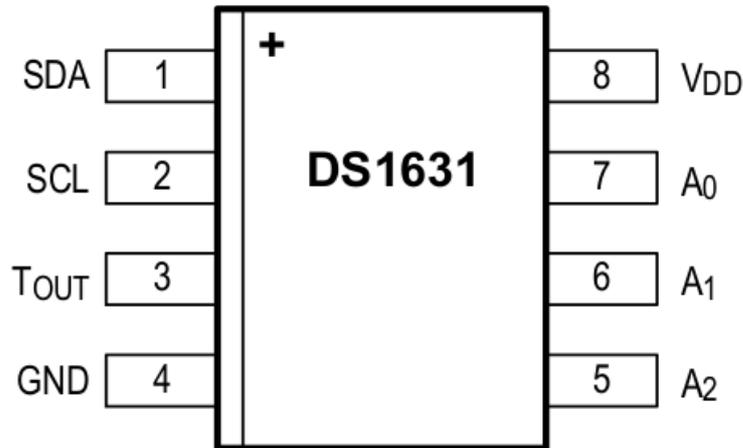
Le thermomètre/thermostat DS1631 (Dallas Semiconductor) fait parti de la famille des capteurs "intelligents" : sur la même puce, il y a un capteur de température classique associé à une électronique d'interface (convertisseur analogique - numérique, contrôleur avec son jeu d'instructions, EEPROM, port série synchrone : bus I2C).
